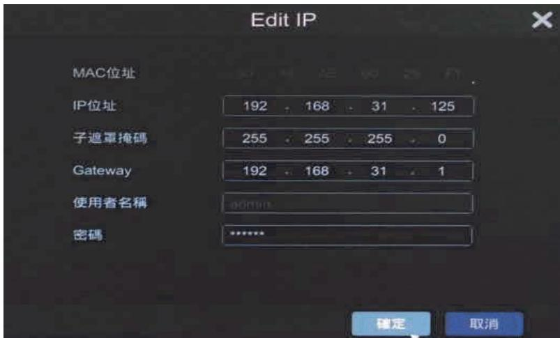
在已增加的 IPC 列表中點擊 可編輯 IPC 的 IP 頻道訊息。如下圖所示，輸入攝像機新的 IP 頻道名稱、IP 位址，然後輸入攝影機的使用者名稱和密碼，點擊【確定】保存修改。點擊【下一步】繼續。
