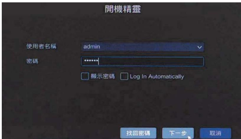
點擊【找回密碼】按鈕可進行使用者密碼找回設定。點擊【下一步】繼續，點擊【取消】可退出安裝導覽。
