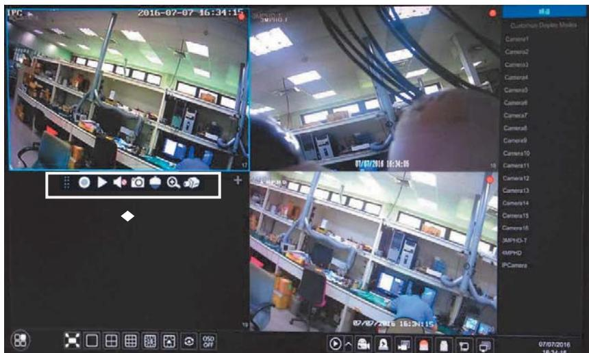
滑鼠左鍵單擊圖像視窗，在視窗底端出現視窗工具列（如上圖區域）；右鍵單擊 圖像視窗，出現右鍵選單欄。視窗工具列與右鍵選單欄介紹如下：
