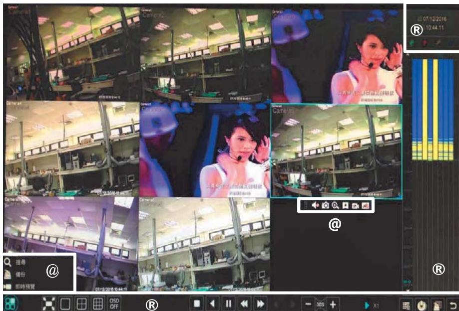
已增加的預覽頻道將自動進入回放介面進行回放。也可手動增加回放頻道，點擊回放頻道視窗上 增加頻道，在彈出的視窗中勾選頻道，點擊【增加】。最大支援16路同時回放。介面底端工具列（如上圖區域）介紹：
