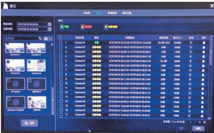
在介面左上角點擊 設定開始時間和結束時間，然後勾選錄影事件類型和頻道，點擊 搜尋，頻道的錄影數據在介面右側清單顯示。點擊 可以小視窗回放錄影 數據，點擊 進行備份。可同時勾選多個錄影數據，點擊【備份】進行備份。
